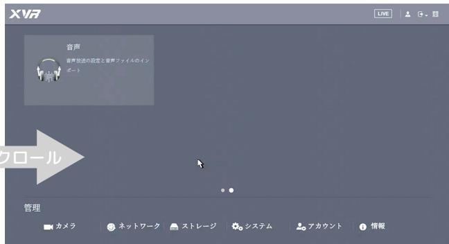
カメラ…接続されたカメラの色彩調整、PTZ 設定、画面表示設定を利用できます。
