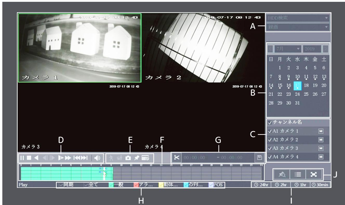
これは録画映像の再生画面です。操作パネル「検索」もしくはメインメニュー「検索再生」から表示できます。画面下部 F のタイムゲージは 24 時間を指し、緑色に塗りつぶされた箇所が再生可能地点であります。塗りつぶされた箇所でダブルクリックするとクリックされた地点から再生開始されます。この画面では B のカレンダー、F タイムゲージより 2019 年 7 月 17 日 8 時 12 分頃を再生していることがわかります。現在タイムゲージの目盛は 24 時間ですが、I 項目より目盛を変更できます。また H 項目より映像データの対象を絞り込むことができます。
