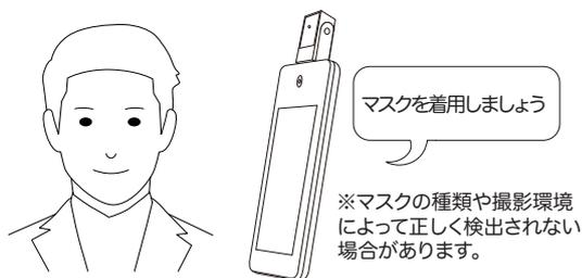
マスクを着用していない被測定者を検出した場合、アナウンスが自動的に再生されます。また測定データにもマスク着用状況が記録されます。
