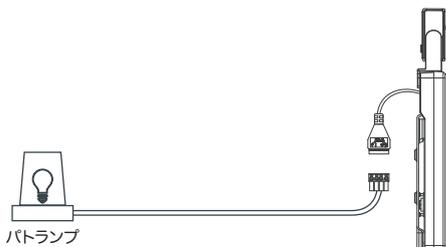
パトランプを用意し、サーモシステムのアラームポート部品へ接続します。接続方法は、ランプメーカーによって異なります。配線や電源については、ランプメーカーへご確認ください。
