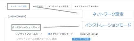
本製品には、2つの機能切替モードが存在します。スタンドアロンモードは初期設定値であり、製品の細かな設定を行えます。特筆すべきは、外部出力機能を利用できる点です。これによりランプ点滅などの外部機器連携が可能となります。プラットフォームモードは、スマートフォンアプリへの通知機能を利用でき、記録データダウンロードも行えます。必要に応じ、切り替えながらご利用ください。
